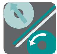
Einzug von Verbundpapier bei gelöster Doppeleinzugs- Präventionswalze.
